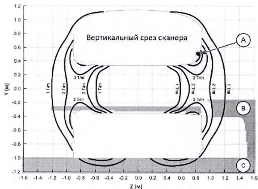
Рисунок 11. Распределение пространственного градиента магнитного поля B_0 (вид сбоку).
