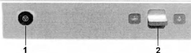
Рис. 7: Кнопка аварийной остановки стола (1) и кнопка возобновления (2) (тумблер служит для возобновления перемещений деки стола).
