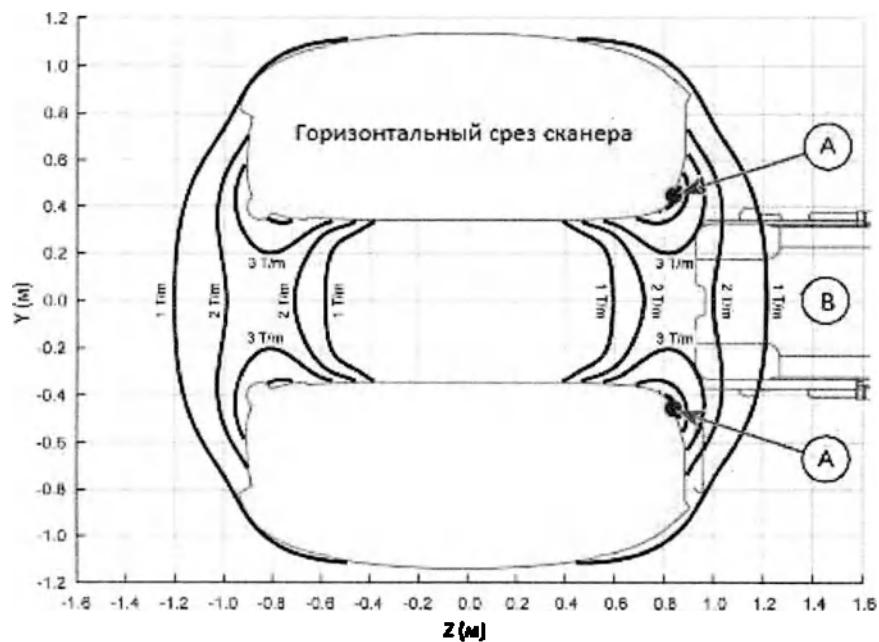
Рисунок 10. Распределение пространственного градиента магнитного поля B_0 (вид сверху).
