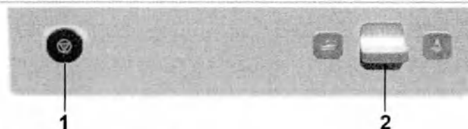
Рис. 3: Кнопка аварийной остановки стола (1) и кнопка возобновления (2) (тумблер служит для возобновления перемещений деки стола).
