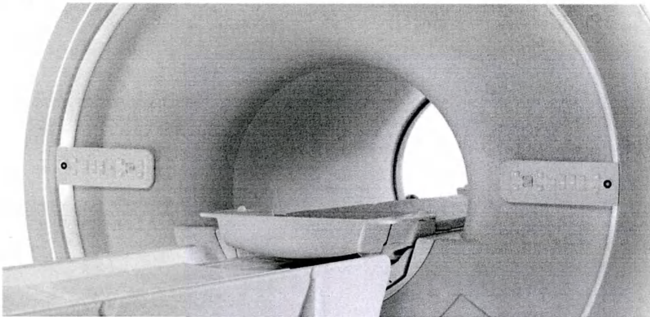
Рисунок 20. Встроенная в туннель системная катушка dS Body.
