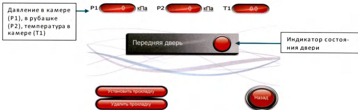
Рисунок 25 – Экран «Обслуживание прокладки» (непроходной тип)
