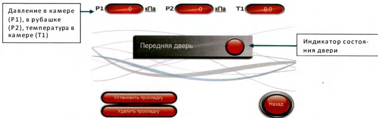
Рисунок 25 – Экран «Обслуживание прокладки» (непроходной тип)
