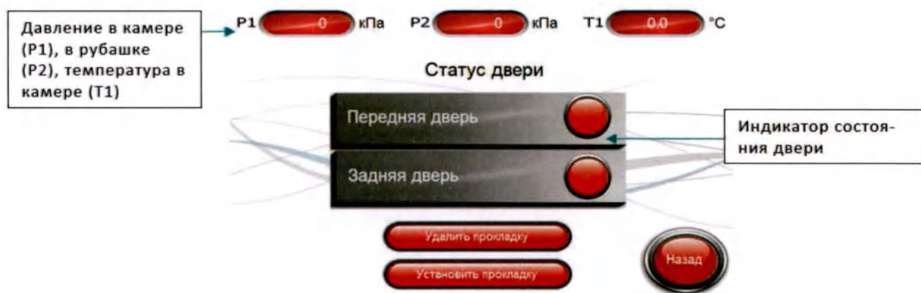
Рисунок 25а – Экран «Обслуживание прокладки» (проходной тип)
