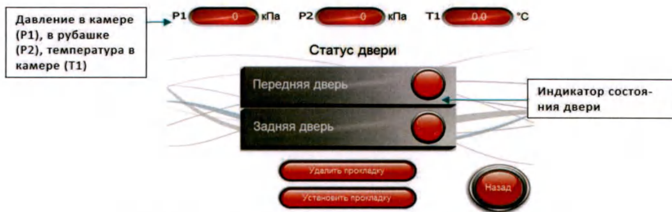
Рисунок 25а – Экран «Обслуживание прокладки» ( проходной тип)
