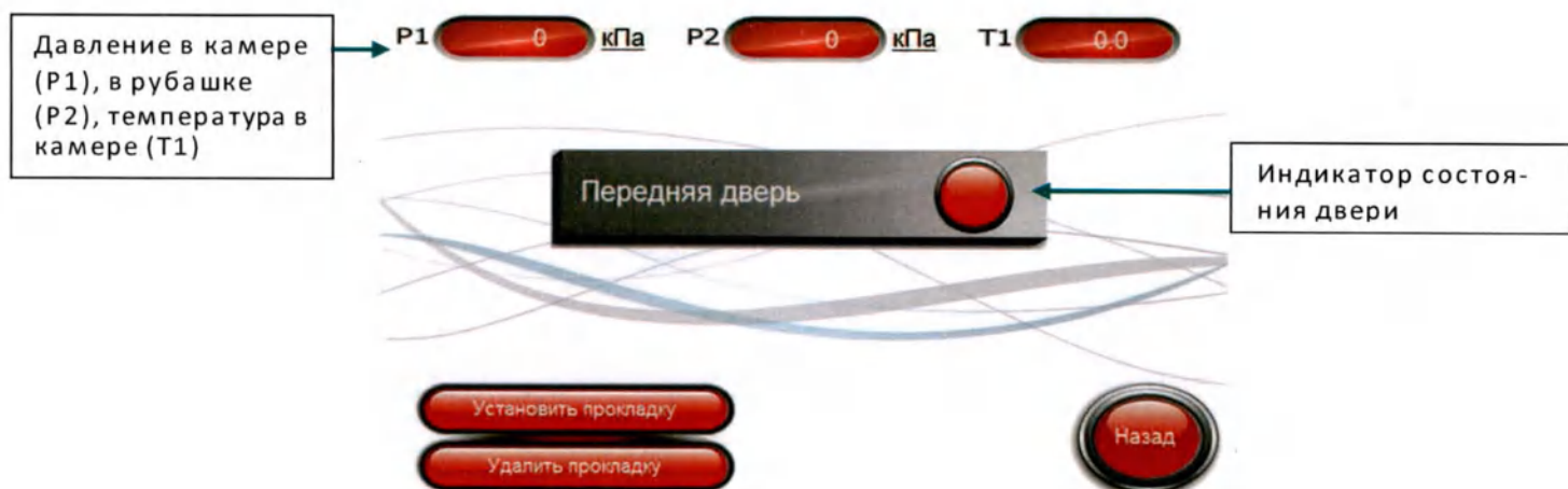
Рисунок 25 – Экран «Обслуживание прокладки» (непроходной тип)
