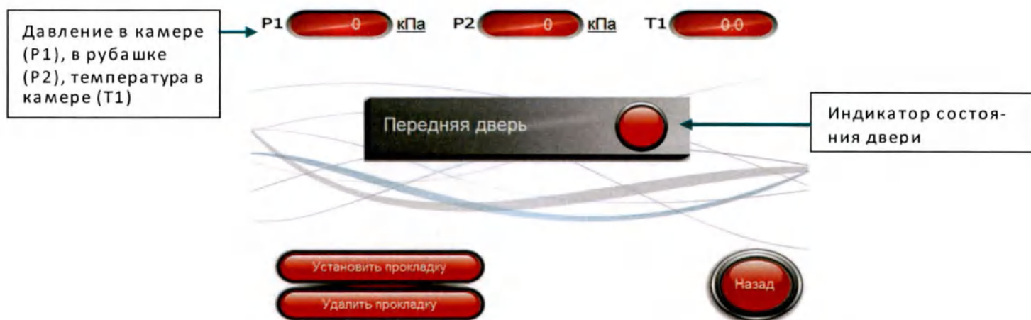
Рисунок 25 – Экран «Обслуживание прокладки» (непроходной тип)
