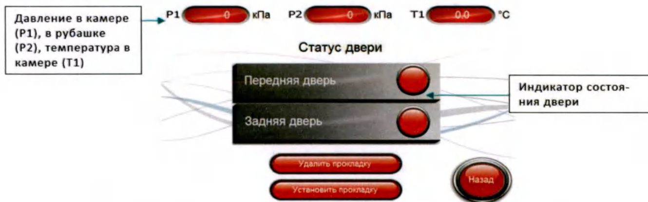
Рисунок 25а – Экран «Обслуживание прокладки» ( проходной тип)
