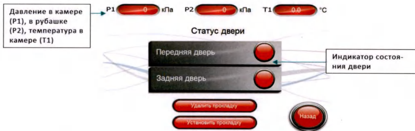
Рисунок 25а – Экран «Обслуживание прокладки» ( проходной тип)
