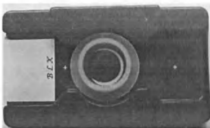
Рисунок 8 – Осадочная камера зафиксирована в держателе для предметных стекол
