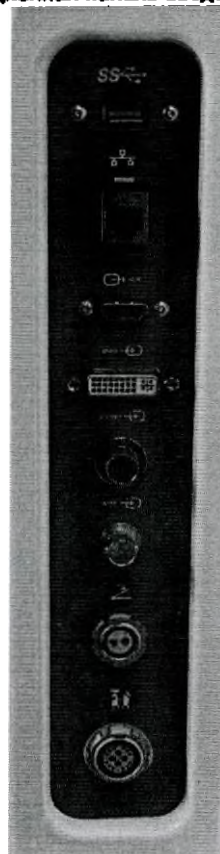
Рис. 15. Коммуникационная панель ввода/вывода главной стойки
