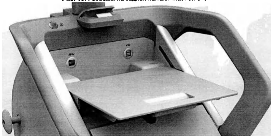
Рис. 16. Разъемы на задней панели главной стойки
