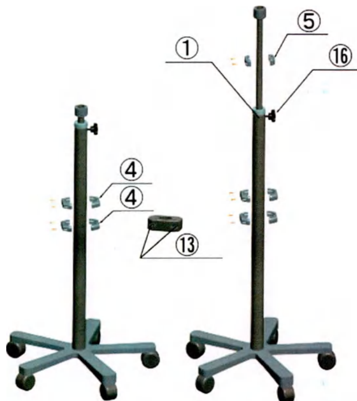
Рисунок 4.1.5-4 Регулирование высоты телескопического штатива и установка зажимов А/В и зажима С
