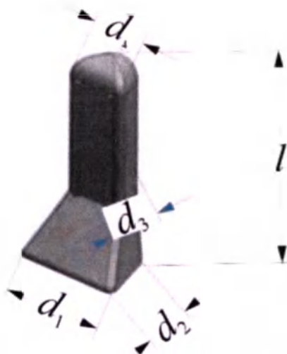
Рис. 9 Схема общего вида колпачка для иглы
