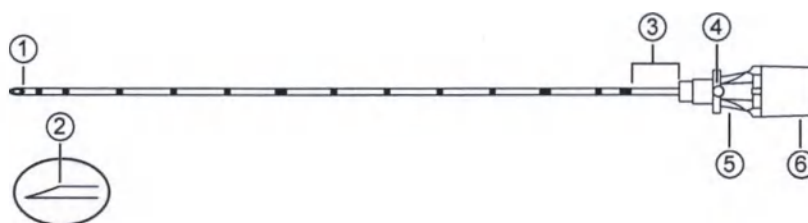
Рис. 7. Игла для введения в отверстие с заранее установленным стилетом
