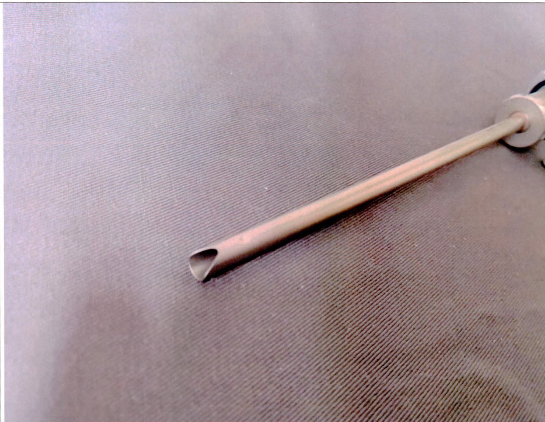
Рис. 20. Тубус артроскопический с зажимным соединительным механизмом, с одним поворотным краном, диаметр 5,5 мм, длина 13,5 см. Имеет схожий внешний вид, отличается цветовой маркировкой и кол-вом поворотных кранов:
