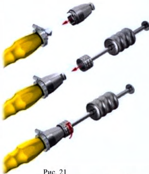
Рис. 21 Сборка ортопедического молотка
