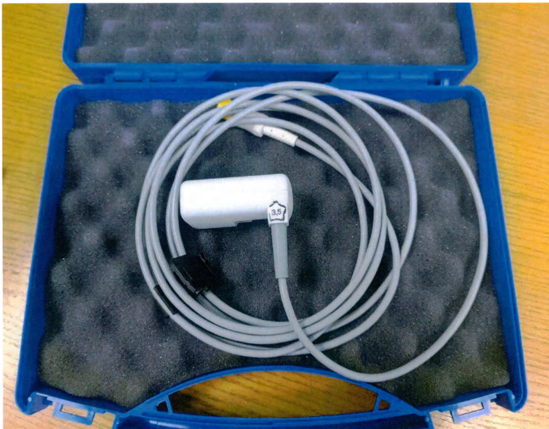
Рисунок 14. Датчик для измерения концентрации CO_2 в выдыхаемом воздухе MCable «Mainstream CO_2 »
