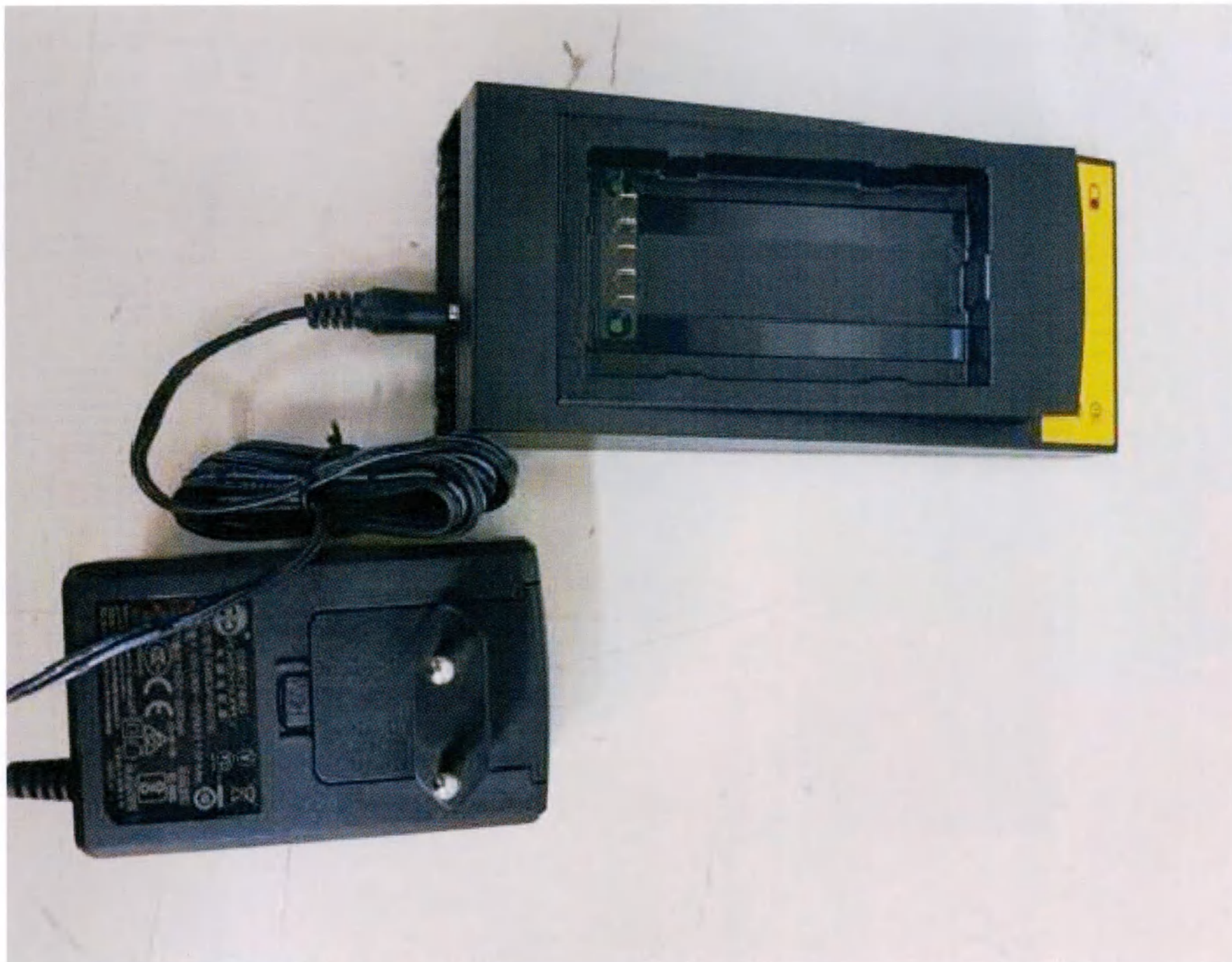
Рисунок 8. Зарядное устройство для батареек, в составе: Адаптер питания зарядного устройства; Сетевой блок питания
