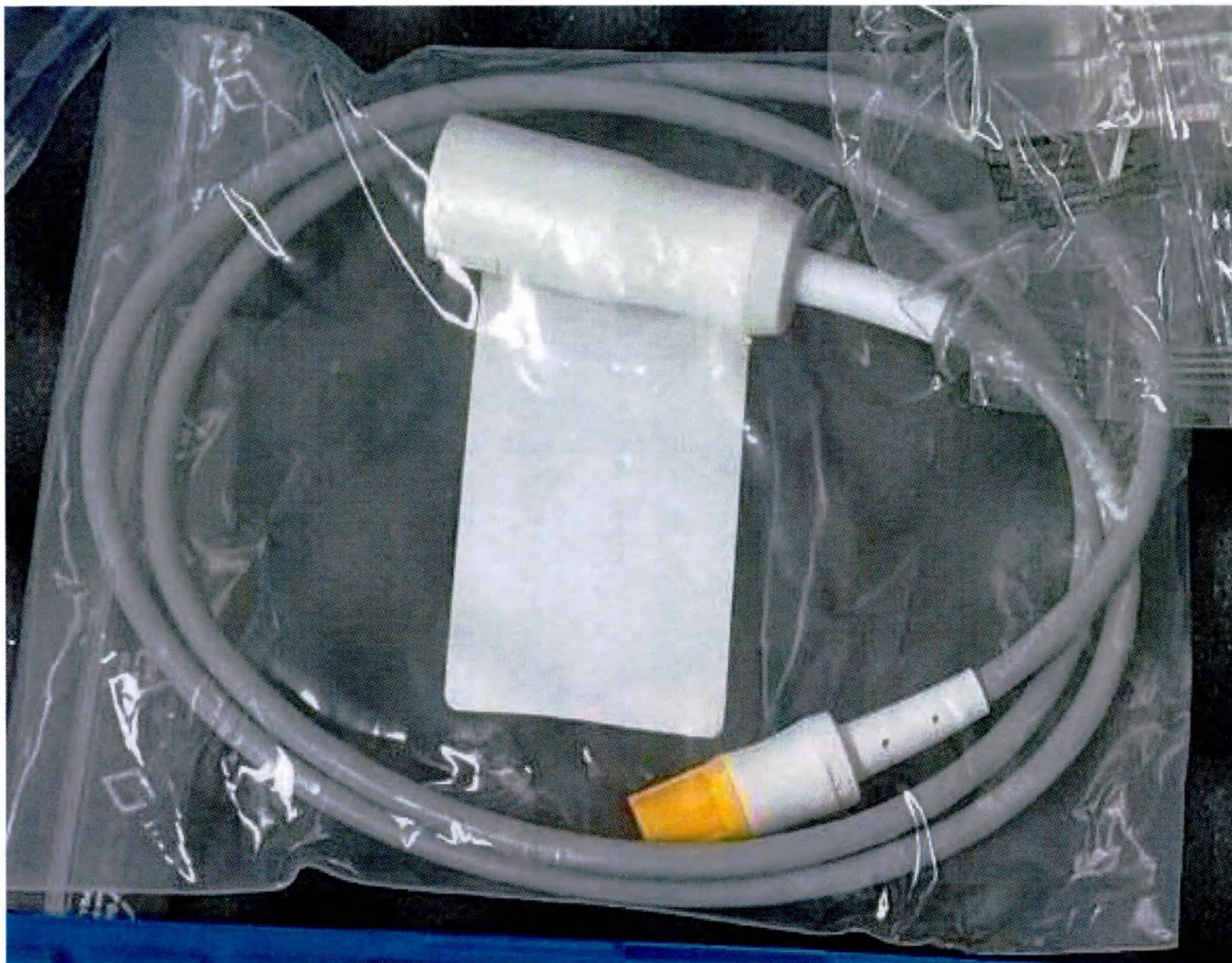
Рисунок 16. Кабель удлинительный для датчика CO2 MCable, 90 см
