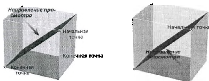
Рисунок 10.7 Направление просмотра изображения косой проекции
