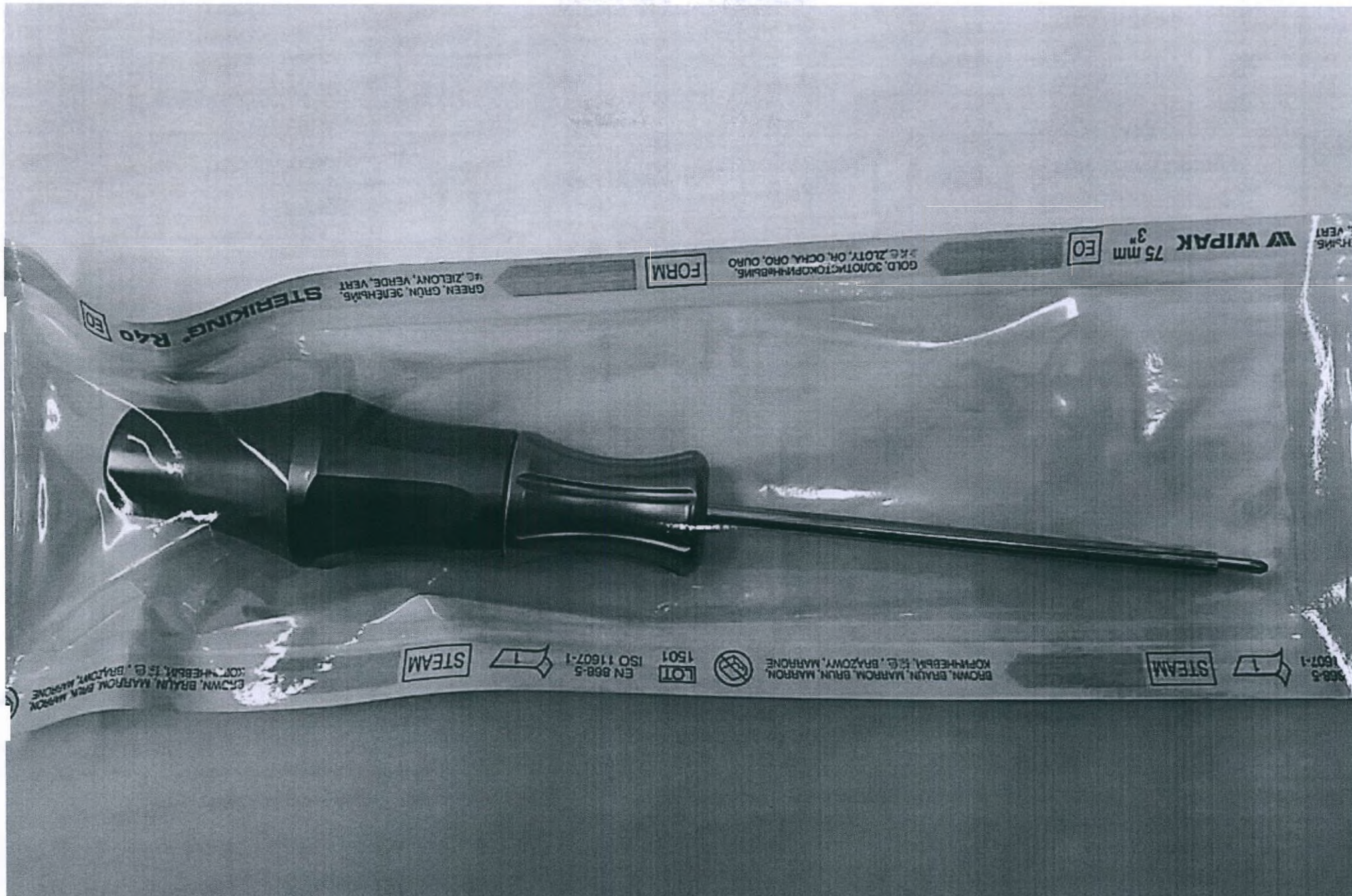
Отвёртка поворотная S=0.6 мм (крест)
