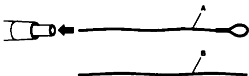
Рисунок 106 — Ввод проволочного очистителя
