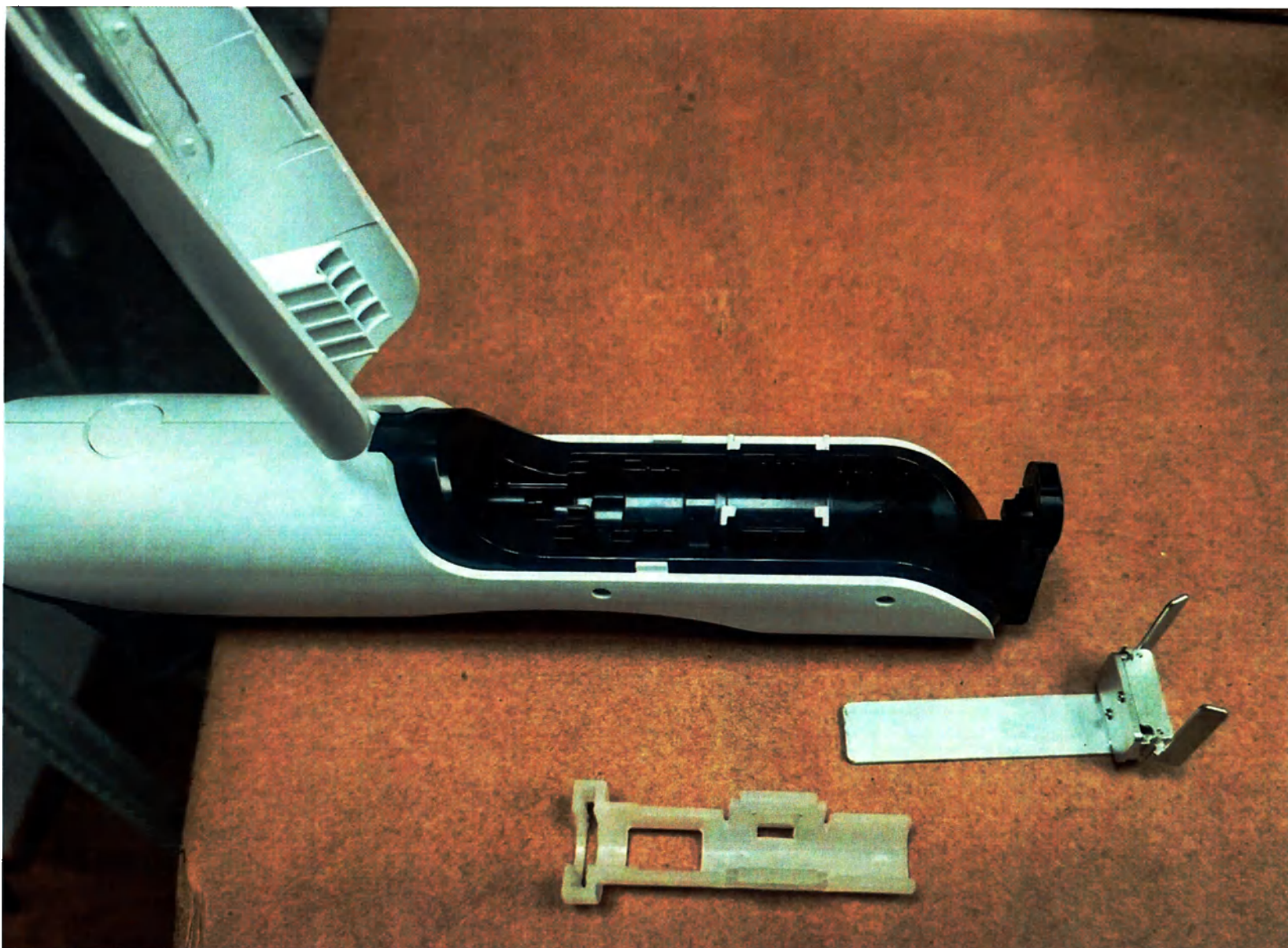
Рис. 12 – Изображение манипулы: вид сверху с открытой крышкой и видом на разъем для соединения с шприцем. (отдельно от держателя-переходника и направляющего охлаждающего наконечника)
