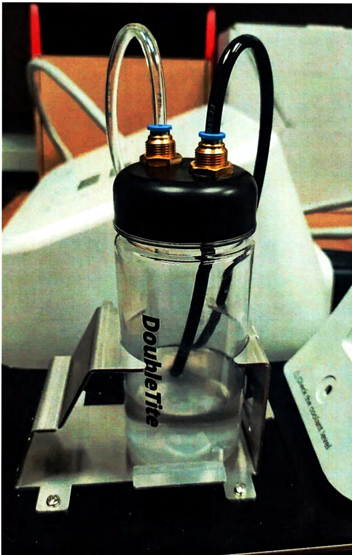
Рис. 10 – Изображение резервуара для деионизированной воды, являющегося конструктивной частью держателя манипулы, и расположенного внутри него. Применяется для обслуживания аппарата.
