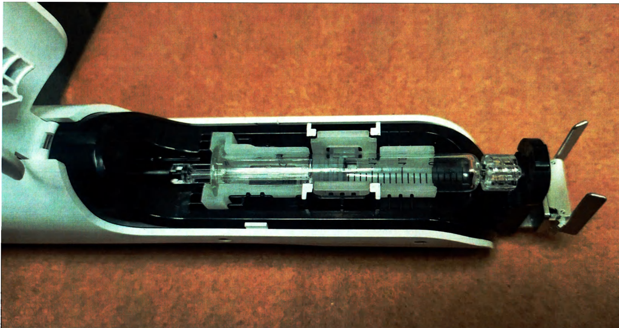
Рис. 34 – Изображение манипулы в сборе с направляющим наконечником, держателем-переходником, штоком и совместимым шприцем объемом 3 мл
