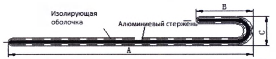
Рисунок 4. Схематическое изображение стилета для эндотрахеальных трубок
