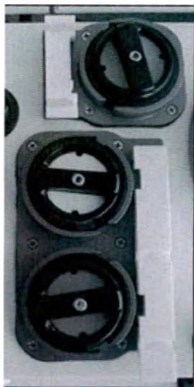
Рис. 3-6 Примеры адаптеров обвязки блока сдвоенных насосов
