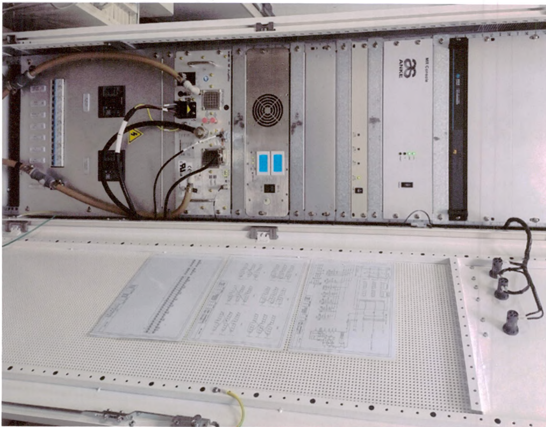
Аппаратный шкаф в составе: спектрометр, радиочастотный (РЧ) усилитель, блок управления, блок питания стола снимков, блок распределения питания (PDU), система синхронизации с физиологическими показателями пациента
