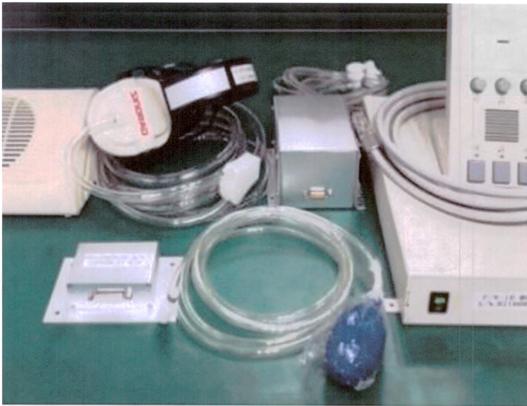
Переговорное устройство в составе: основной блок переговорного устройства, терминал, сигнальная груша, наушники, преобразователь электроакустический, коммутатор, динамик
