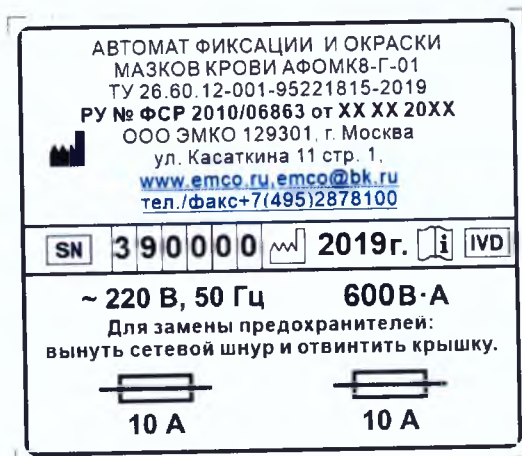
Рисунок 1. Внешний вид заводской таблички.
