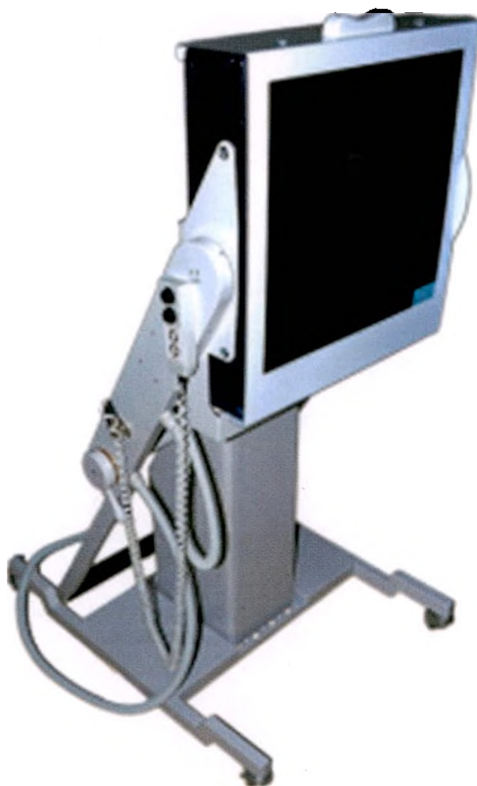
Приемники малодозовые с цифровой обработкой рентгеновского изображения Альфа-В-2500, Альфа-Р-4000 с принадлежностями, ООО «НПК «Телеоптик», Украина
