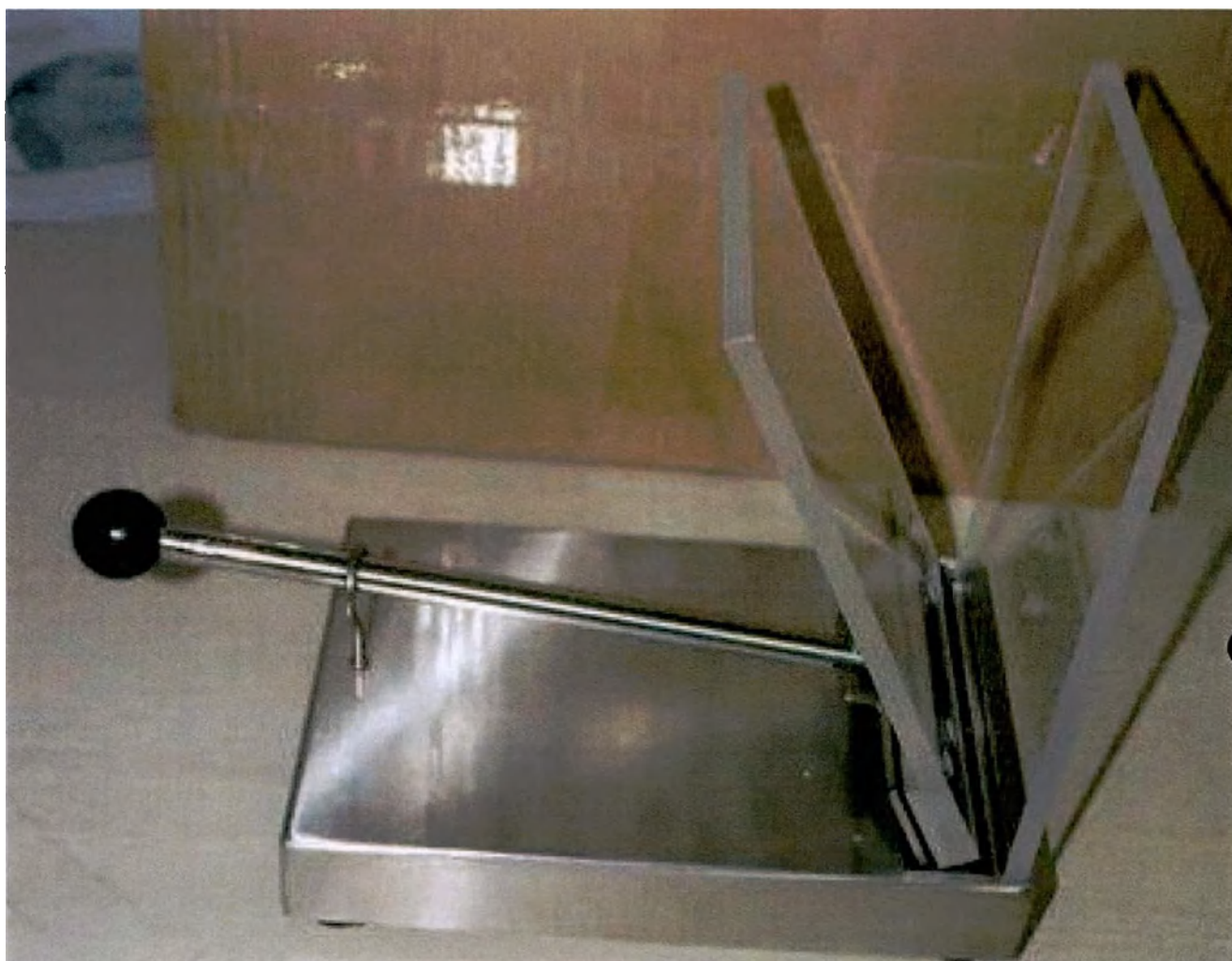
Плазмозкстрактор-устройство настольное для отделения в полимерных контейнерах плазмы крови от эритроцитарной массы "НОСТАЛЬГИЯ" по ТУ 9452-003-11625660-01, ООО «НПИ ФИРМА «ГИПЕРИОН», Россия
