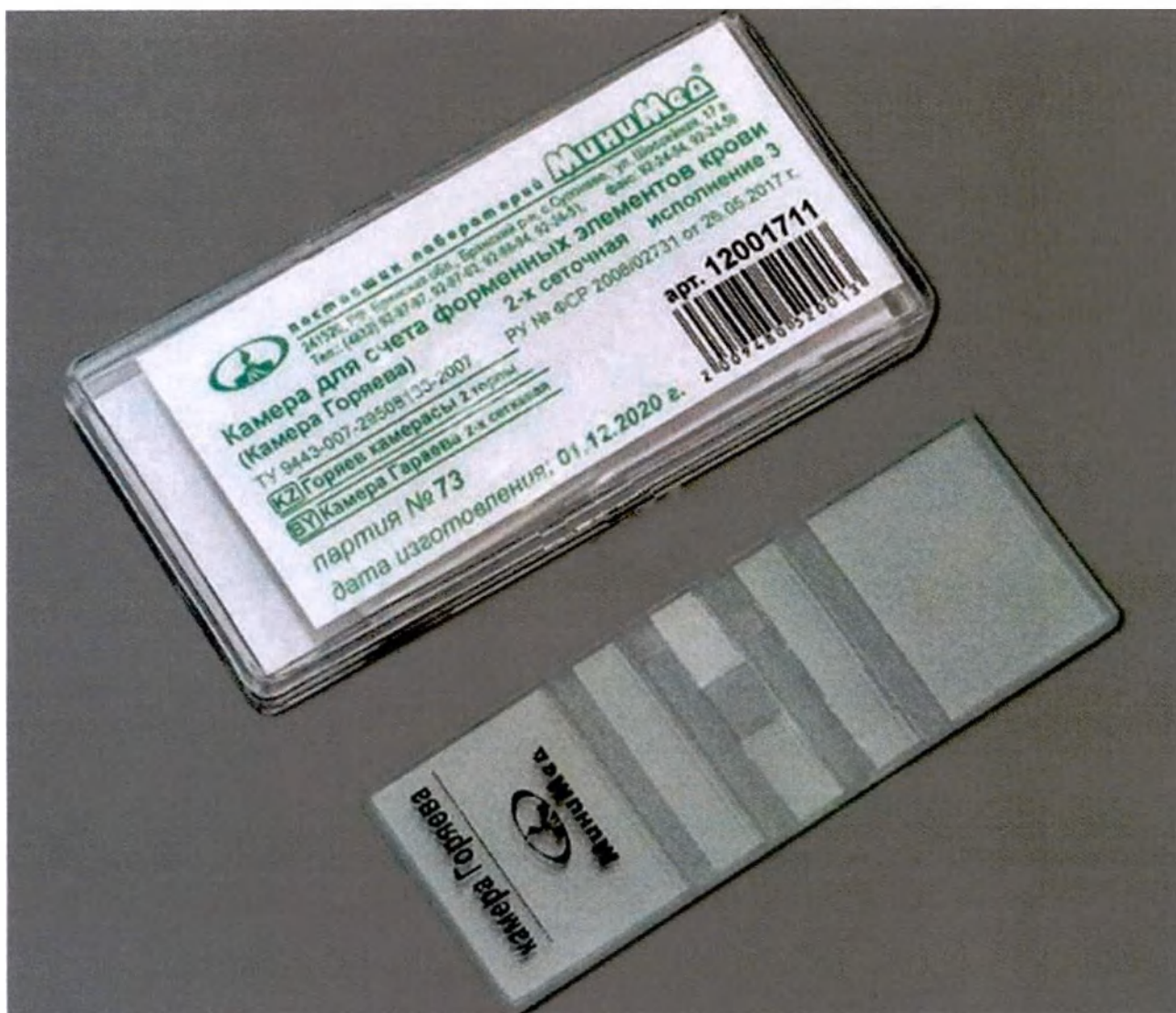
Камера для счета форменных элементов крови (Камера Горяева) по ТУ 9443-007-29508133-2007, ООО «МиниМед», Россия
