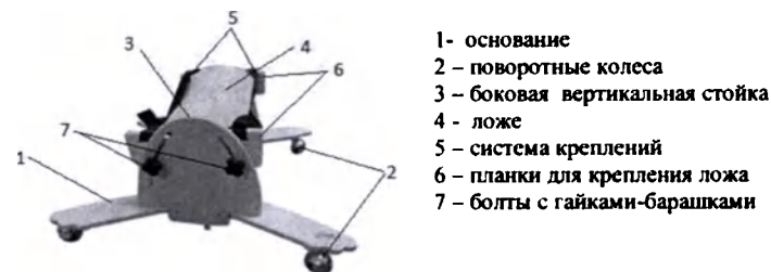
Рис.1-Опора функциональная для ползания для детей инвалидов «Я МОГУ!», исполнение ОП-109.1
