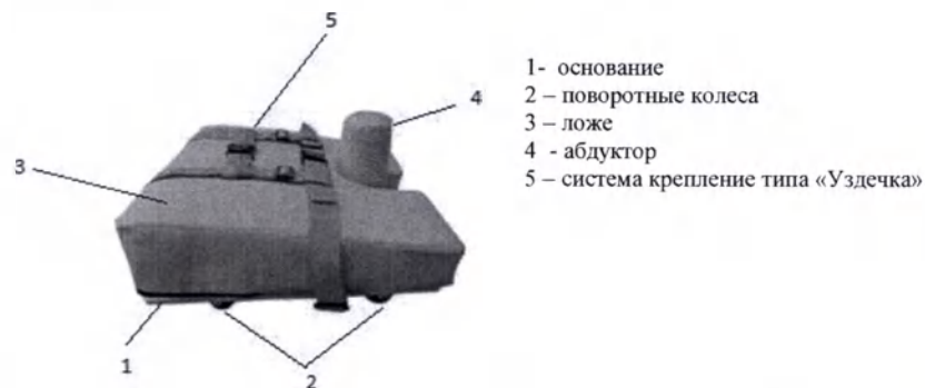
Рис.1-Опора функциональная для ползания для детей инвалидов «Я МОГУ», исполнение ОП-109.2
