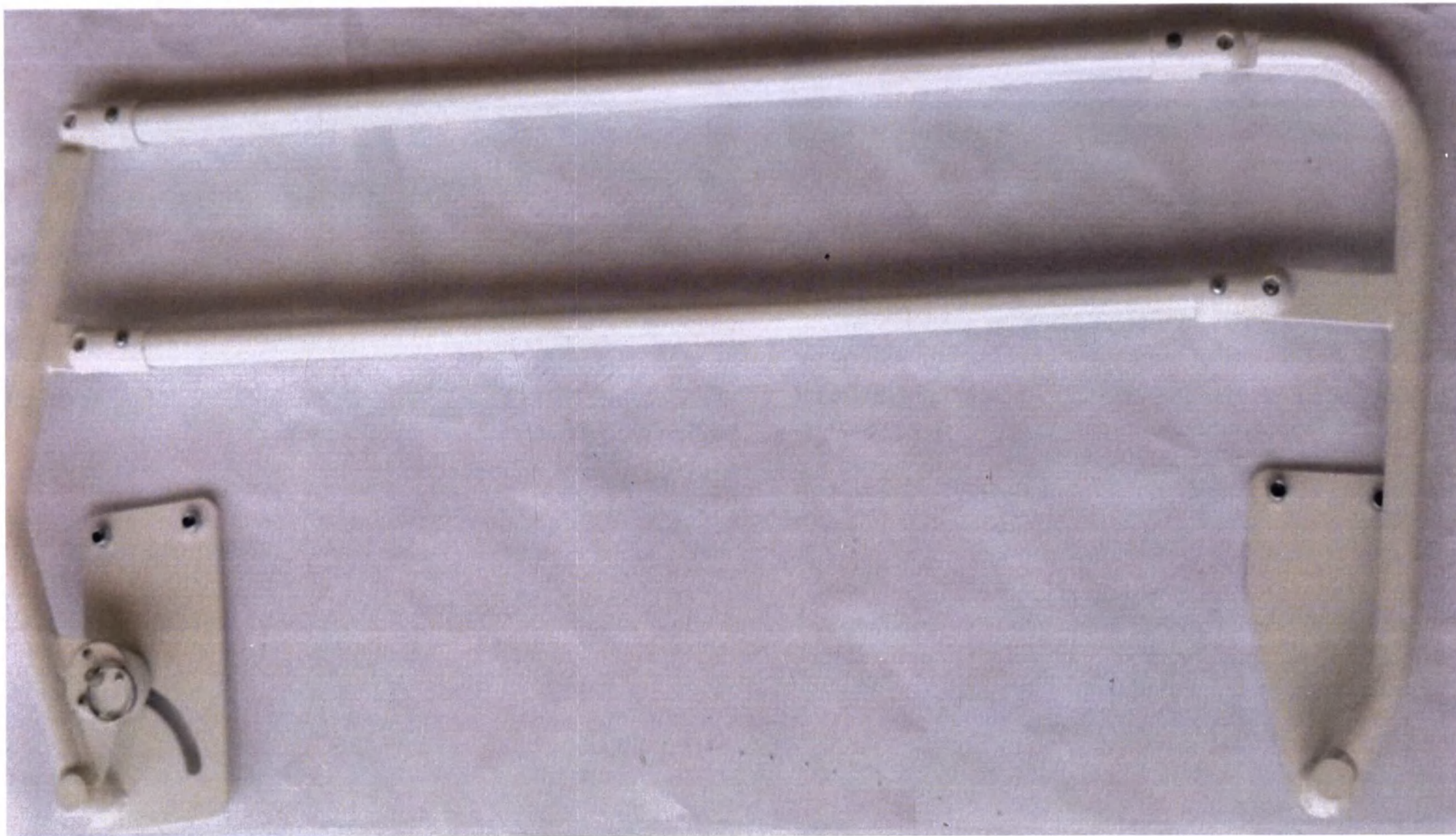
Комплект ограждений (левое и правое), в составе: Ограждение правое ИЯУБ 30.18.01.13; Пластина – 2 шт.; Болт М8 х 40 – 4 шт.; Болт М8 х 45 – 4 шт.; Гайка М8 (контрящая) – 8 шт. Шайба 8 – 8 шт.
