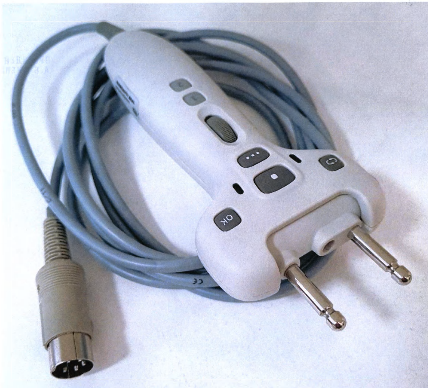
Стимулятор нервов вилочковий с регулируемым межэлектродным расстоянием и поворотным механизмом
