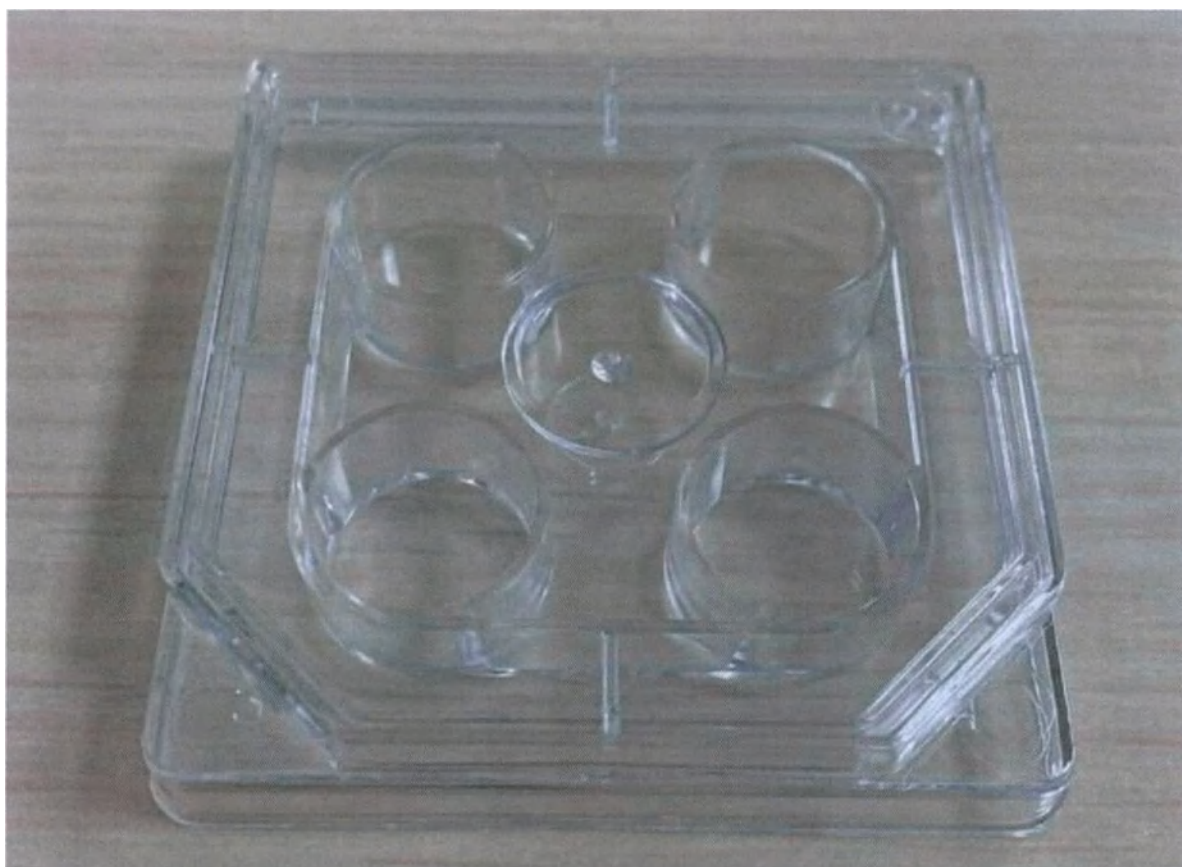
Чашка Петри квадратного типа 65х65 мм, вентилируемая, бесцветная, артикул: DPK65V-1/S Чашка Петри квадратного типа 65х65 мм, вентилируемая, бесцветная, артикул: DPK65V-10/S Чашка Петри квадратного типа 65х65 мм, вентилируемая, бесцветная, артикул: DPK65V-20/S
