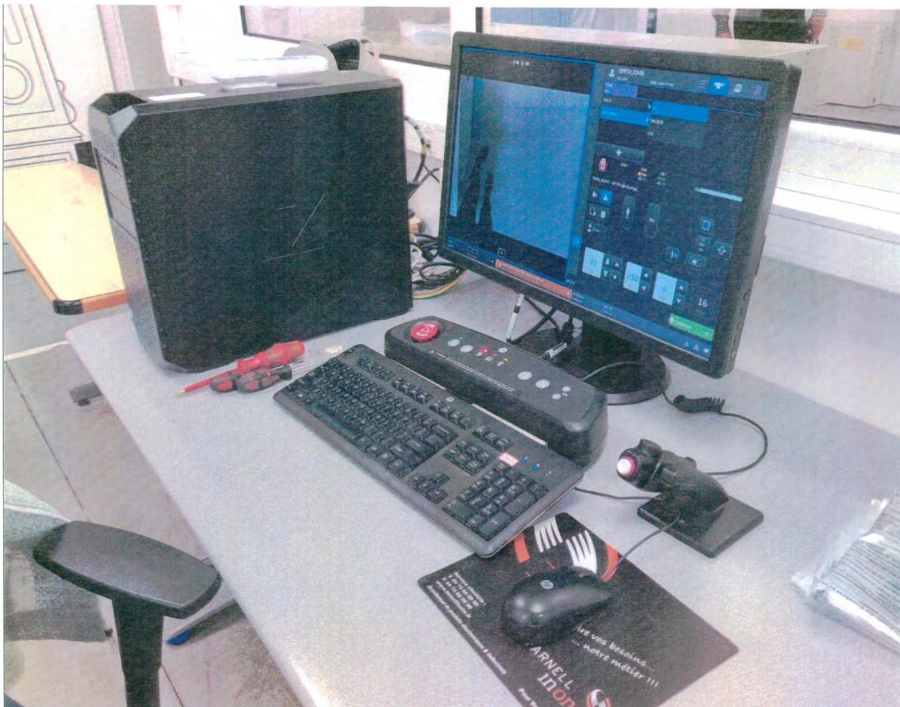
Рис. 9. Рабочая станция получения изображений в составе: Компьютер (1 шт.) Монитор (не более 3 шт.) Буквенно-цифровая клавиатура (1 шт.) Мышь (1 шт.) Интерфейсный модуль рентгеновской системы (RCIM2) (1 шт.) Переключатель пульта управления ручной (1 шт.)
