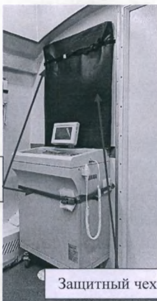
Рис. 90 – Генератор с пультом управления и защитным экраном (транспортное положение)
