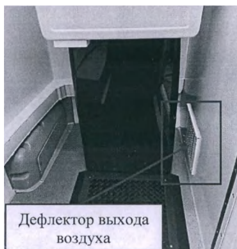
Рис. 62 - Отопитель зависимый в процедурном кабинете (флюорография)
