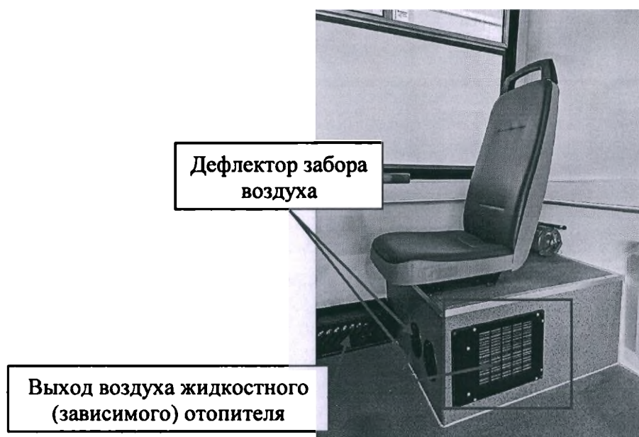
Рис. 61 - Отопитель зависимый в рабочем салоне (флюорография)
