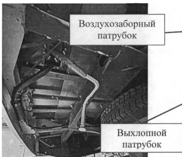
Рис. 54 - Выход автономного отопителя под днищем комплекса (из процедурного кабинета (флюорография))
