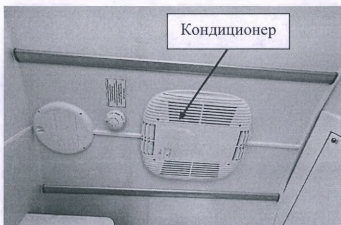
Рис. 70 – Место расположения кондиционера в рабочем салоне (флюорография)
