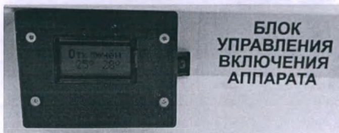
Рис. 93 - Индикаторная панель устройства контроля температуры (кнопка отключена)
