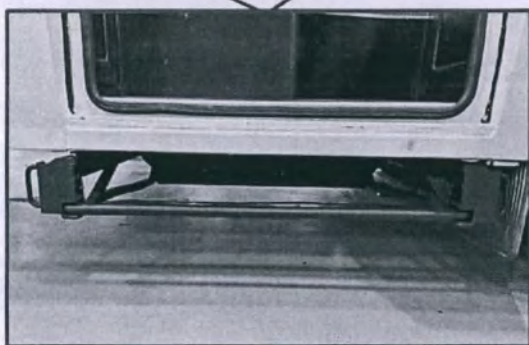
Рис. 109 - Выдвижные подножки комплекса (транспортное положение)
