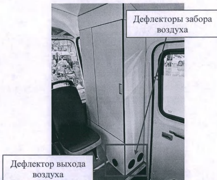
Рис. 47 - Отопитель автономный в рабочем салоне (маммография)
