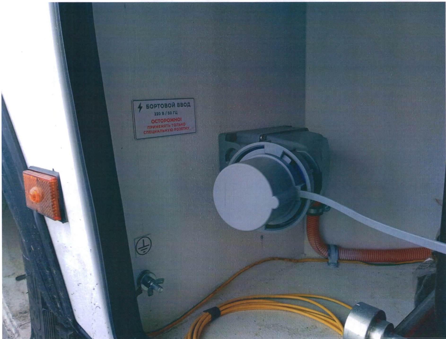
Рисунок 27 – Наружный ввод электропитания от внешних источников
