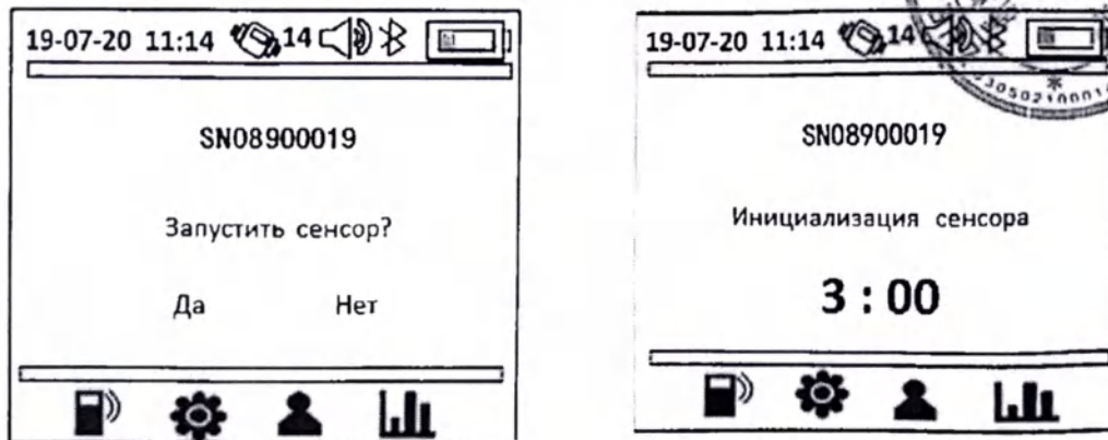
Рисунок 12. Запуск сбора данных датчиком
