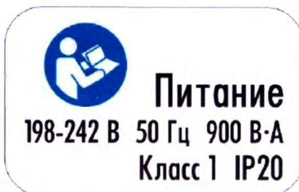
Рисунок 10 – Аппликация на модуле обогревателя со стороны присоединения сетевого кабеля
