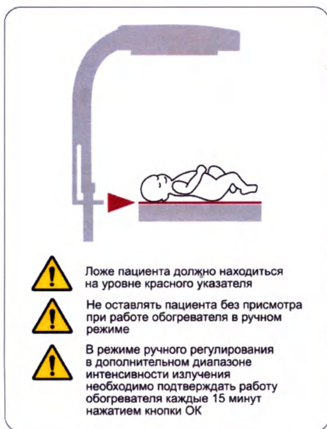
Рисунок 6 – Аппликация на модуле обогревателя
