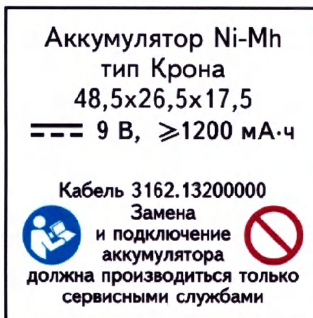
Рисунок 12 – Аппликация на модуле обогревателя
