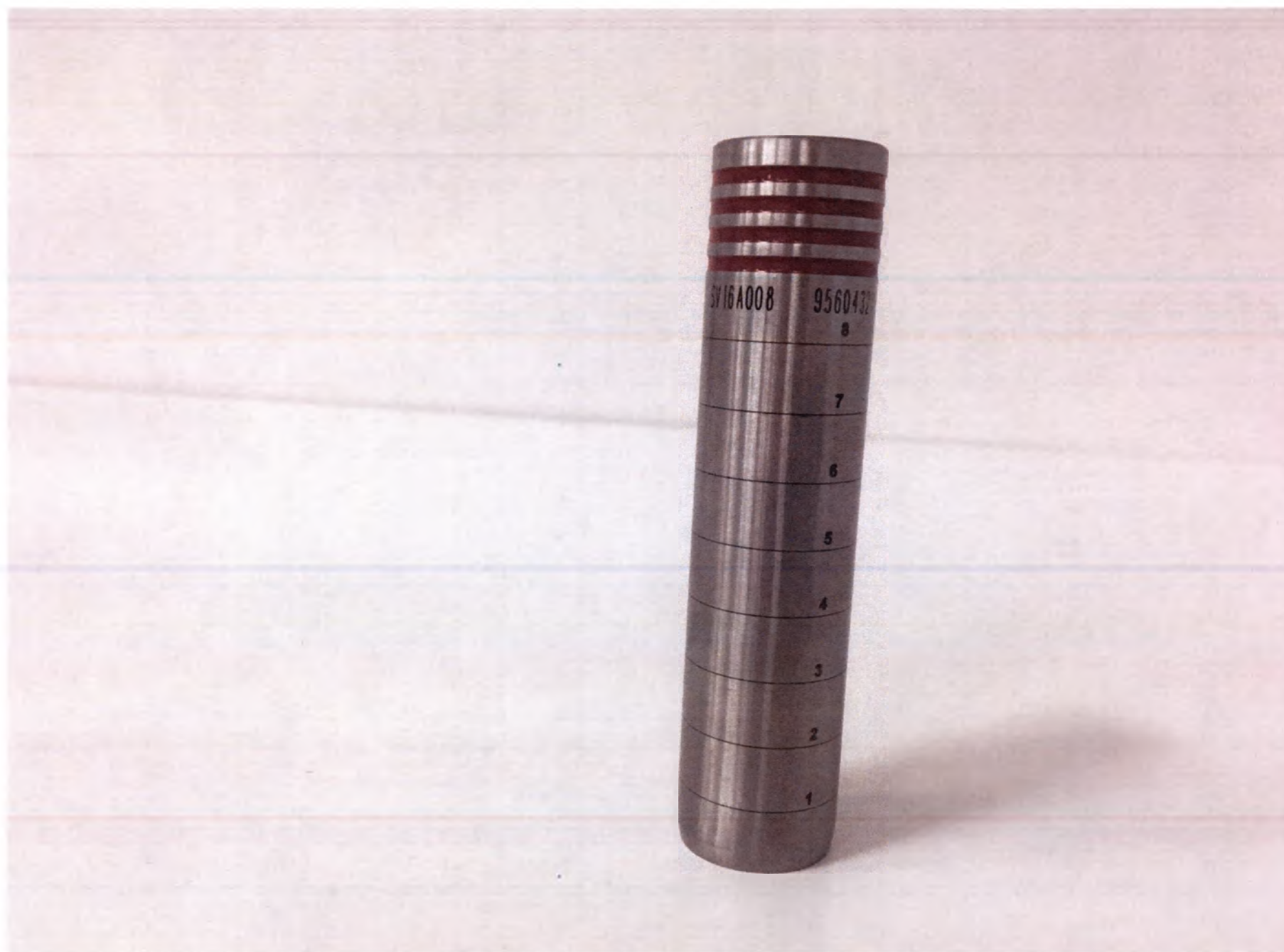
Расширитель Metrх, 24,8 мм.
