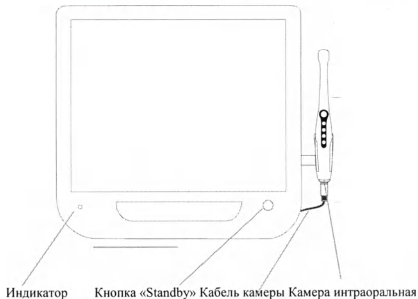
Рис.4 Схематичное изображение камеры интраоральной, установленной в держатель интраоральной камеры
