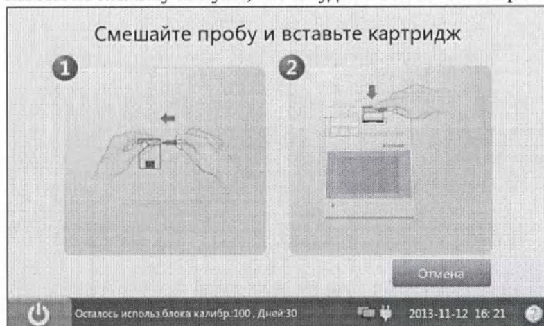
Рис. 6-5 Перемешивание контролей и вставка картриджа
