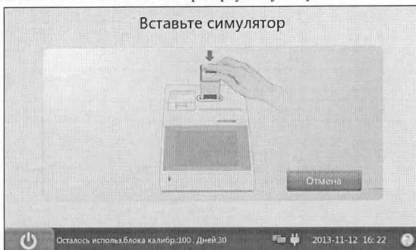
Рис. 6-42 Установка внешнего симулятора
