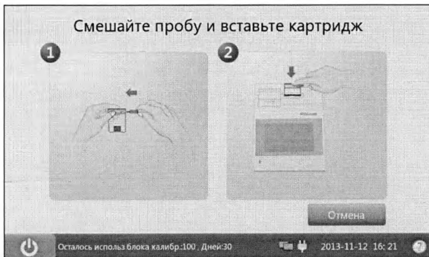
Рис. 6-18 Перемешивание квалификационной пробы и установка картриджа
