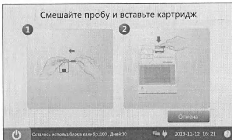
Рис. 6-31 Перемешивание контролей для верификации калибровки и установка картриджа
