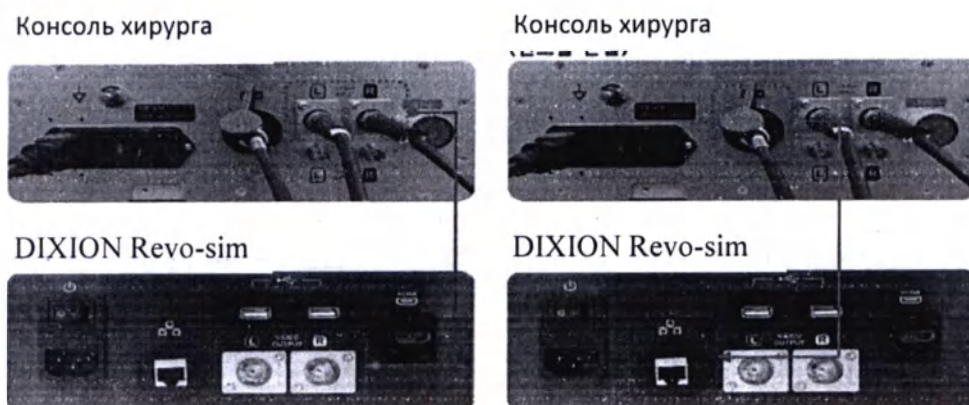
Рис. 6 Соединитель видео кабелей и системного кабеля
