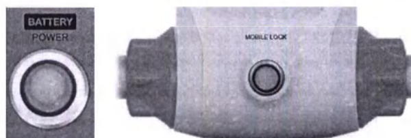
Рисунок 4-7. Кнопка питания операционной консоли от батареи и кнопка блокировки мобильности
