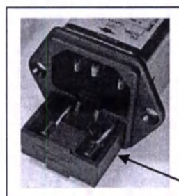
Открытый блок предохранителей
