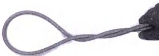
Рисунок 8-2. Неправильное обращение с оптоволоконным кабелем (пример)
