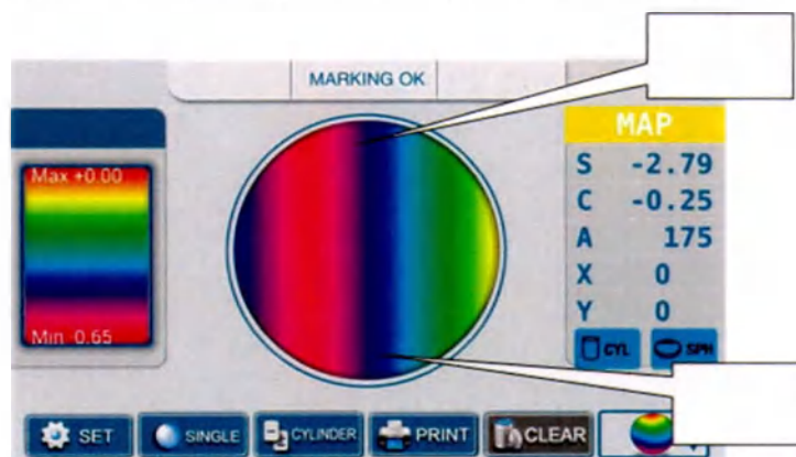
Рисунок Измерение диоптрического профиля
