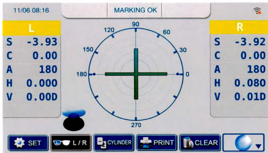
Рисунок Измерение готовой линзы и сохранение данных с левой стороны
