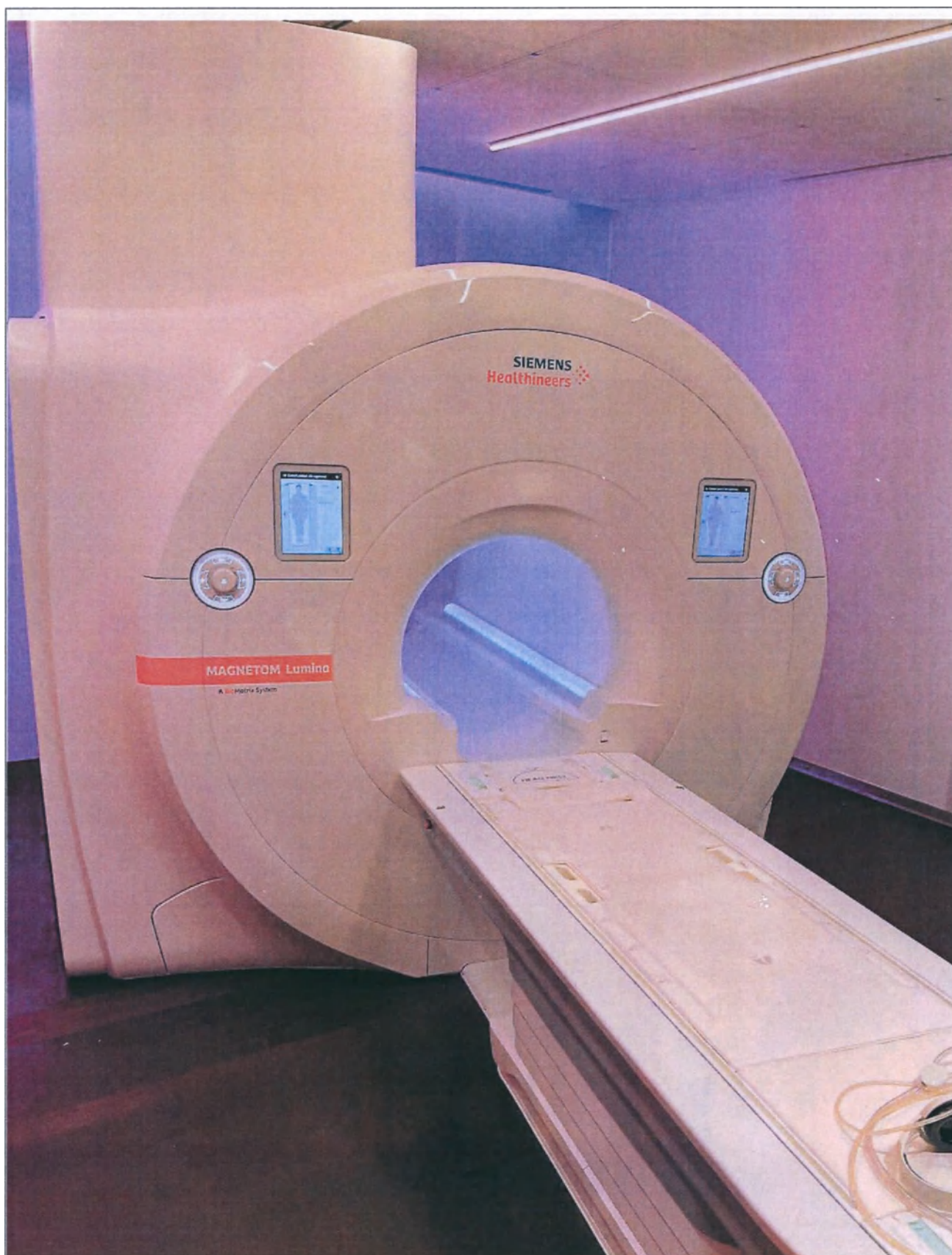
1. Электромагнит сверхпроводящий с активным экранированием и встроенными катушками шиммирования
