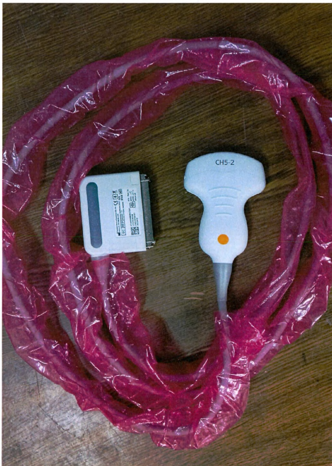
12. Датчик CH5-2 конвексный для абдоминальных и акушерско-гинекологических исследований
