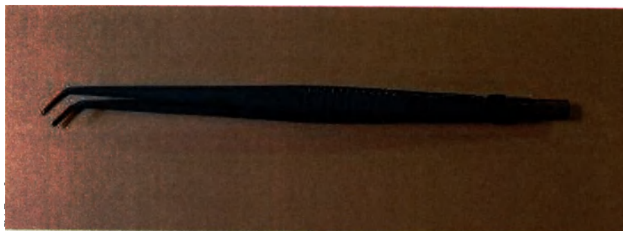
33. Пинцет биполярный изогнутый с плоским штекером (европейский разъём), длина 200 мм, бранши шириной 1мм, 310-142-10. Фото изделия и пример маркировки
