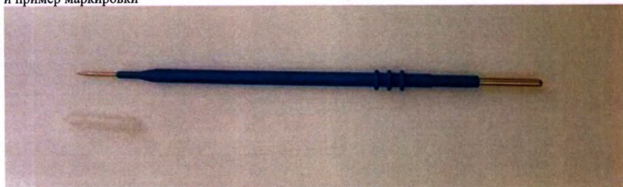
14. Электрод-игла изогнутый, длина стержня 70мм, посадочный диаметр 2,4 мм, 152-122. Фото изделия и пример маркировки
