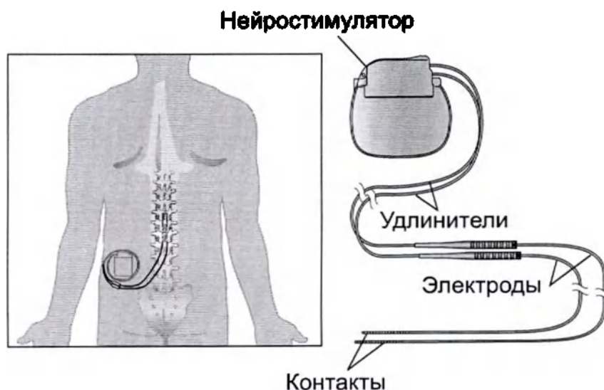
Рис. 2.1 Имплантированные компоненты системы нейростимуляции (показана стимуляция спинного мозга).
