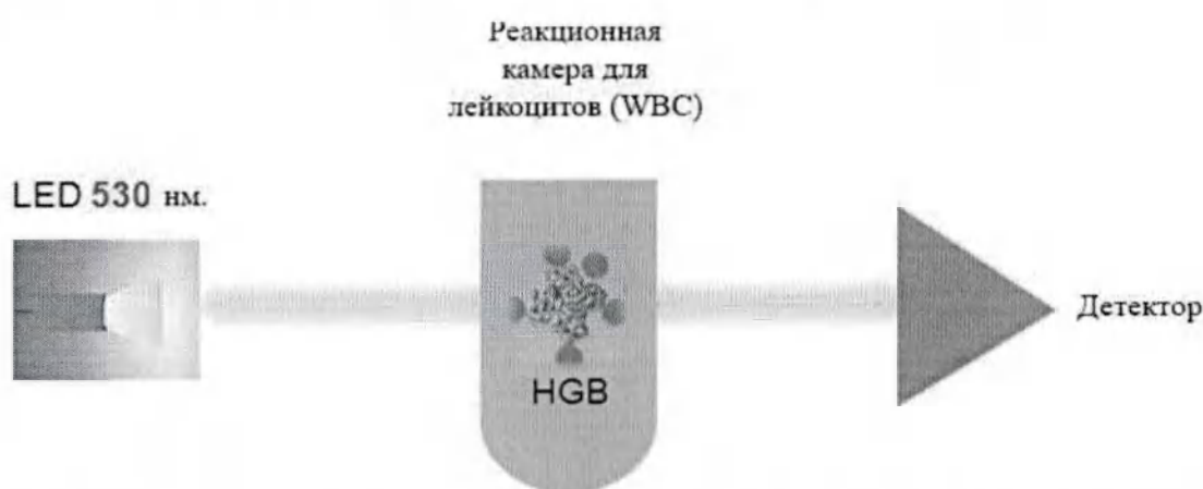
Рис. 4-4. Схематическое изображения измерения гемоглобина при помощи колориметрического метода
