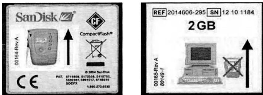
Рис. 9 Изображения на карте памяти показывают, как ее следует вставлять в регистратор SEER® 12 и в картридер.
