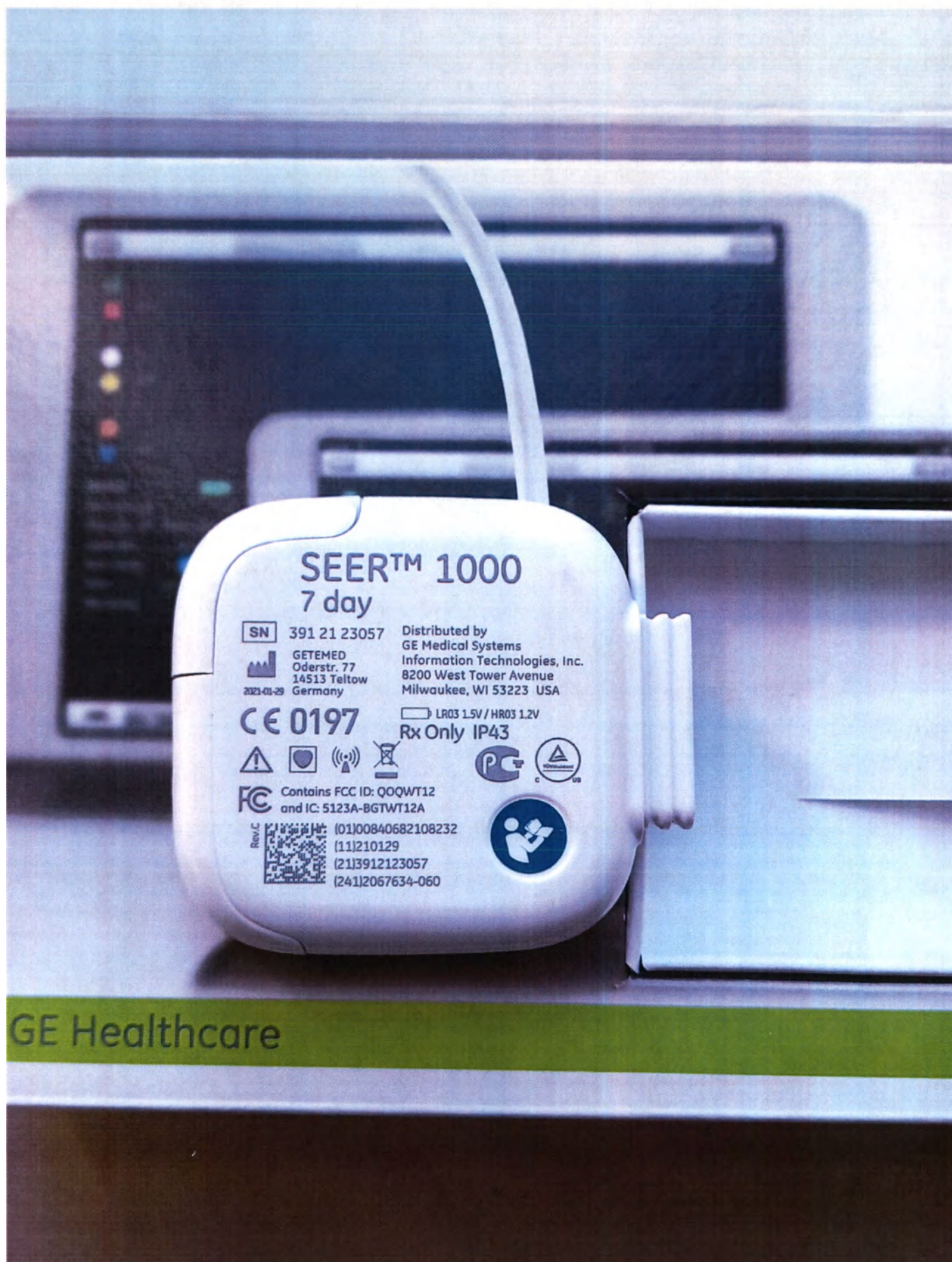
Регистратор цифровой SEER 1000 для 7-дневной записи: задняя сторона корпуса.
