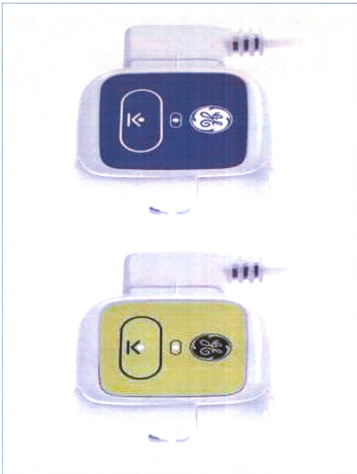
Регистраторы цифровые SEER 1000 для 48-часовой и для 7-дневной записи, с подключенным USB-кабелем для передачи данных: передняя сторона корпуса.
