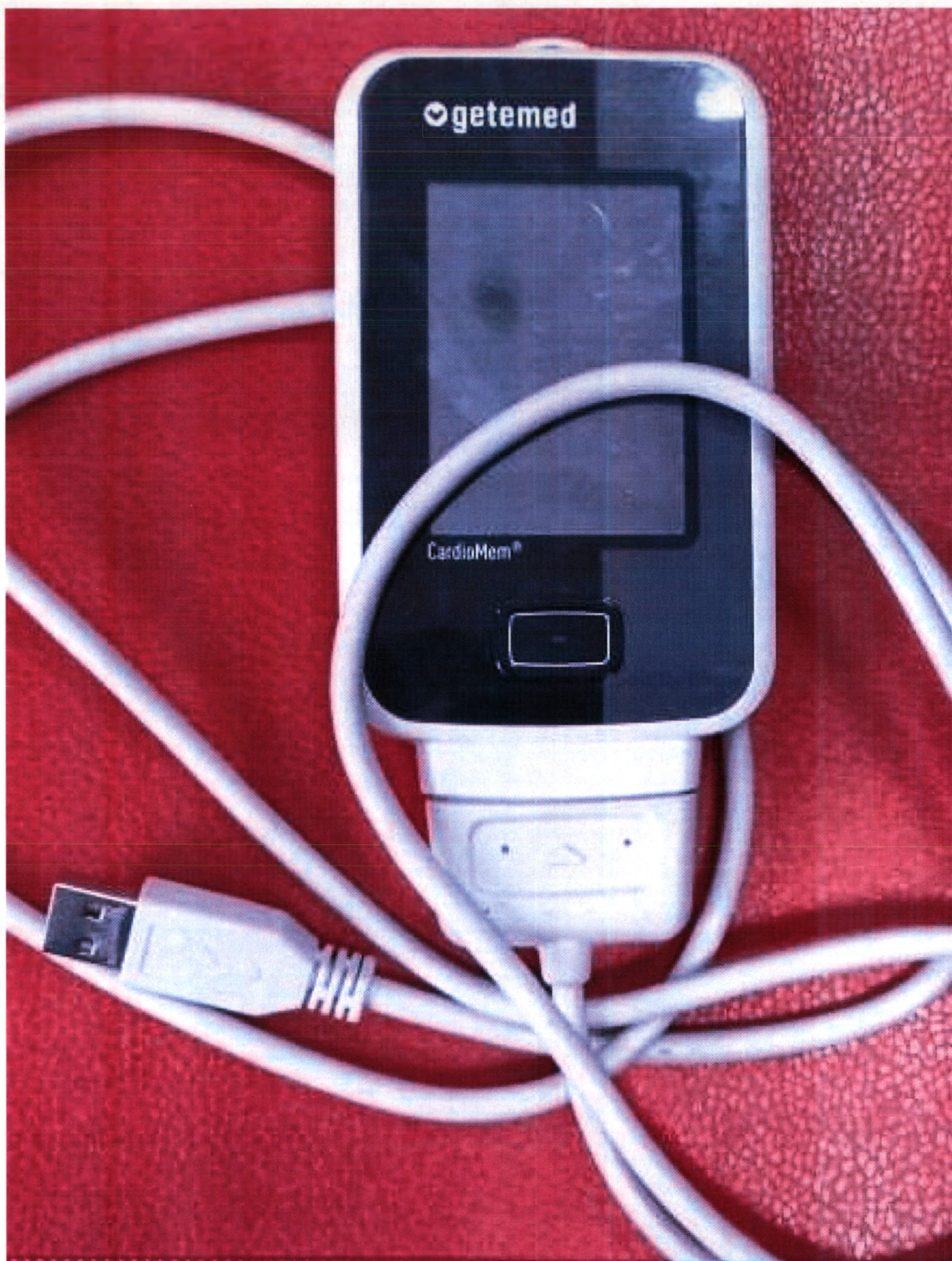
Регистратор цифровой CardioMem CM 4000 B с подключенным USB-кабелем для передачи данных
