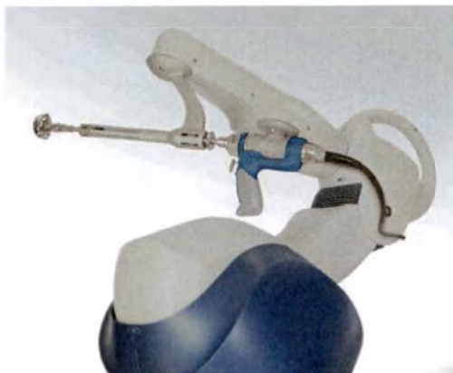
Рисунок 84. Полностью собранный ример и силовое оборудование
