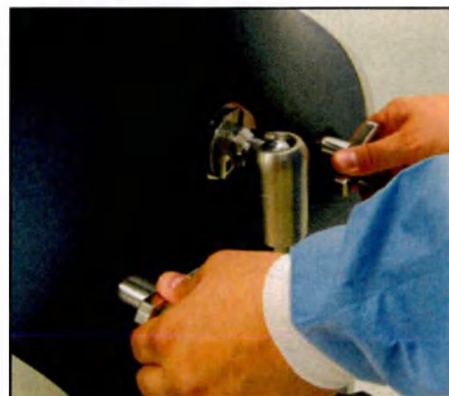
Ослабьте калибровочную штангу
