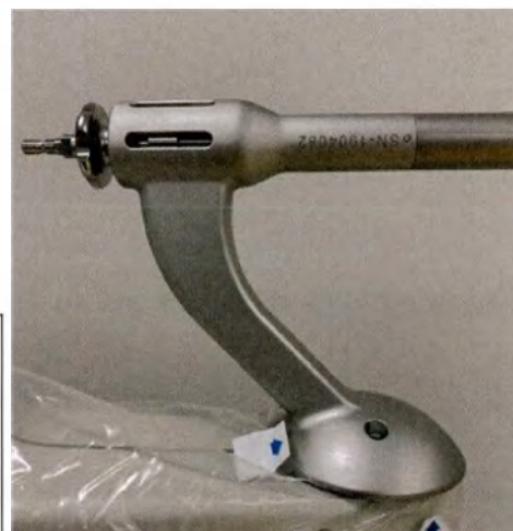
Рукоятка римера, закрепленная в эффекторе
