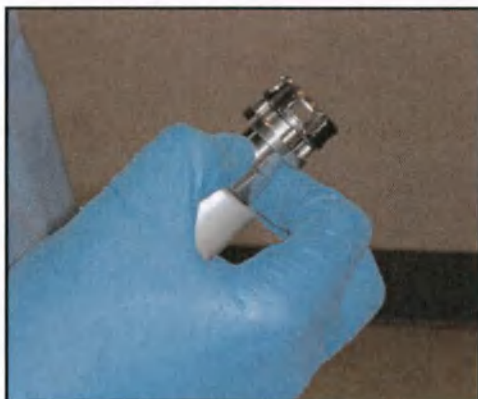
Разблокировка рукоятки римера
