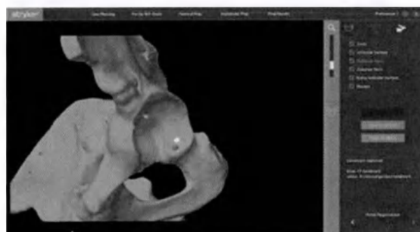
Рисунок 76. Исходное оценочное положение захваченного зондом ориентира (белый) и КТ-ориентира (синий) на модели тазовой кости
