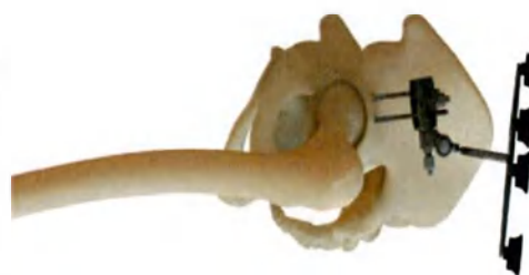
Рисунок 4. Установка переднелатеральной тазовой антенны внутри разреза
