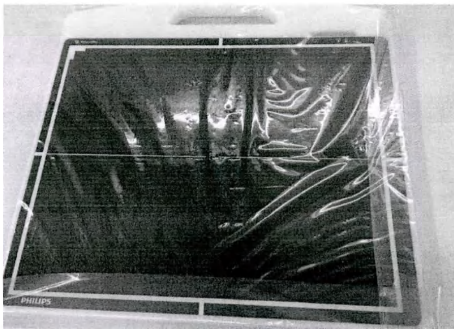
Рисунок 73. Решетка отсеивающая вертикальная 44/8/130 для детектора SkyPlate Pixium 3543 (Вариант 1).
