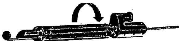
Рис. 74. Присоединение насадки 2 к корпусу манипулы
