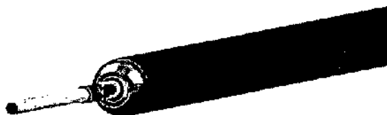
Рис. 71. Фиксация оптического волокна в канюле
