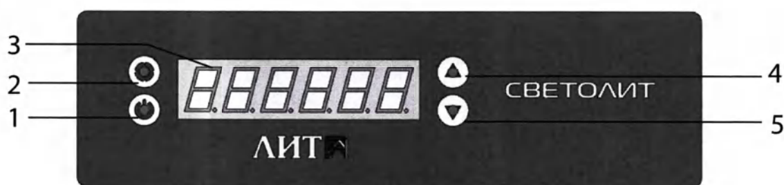
Рисунок 7.2. Расположение элементов на панели управления установки СВЕТОЛИТ-220:
