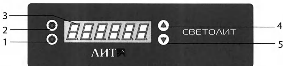
Рисунок 7.2. Расположение элементов на панели управления установки СВЕТОЛИТ-150:
