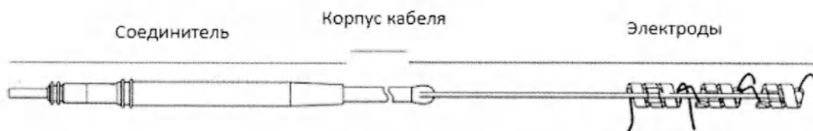
Рис. 14.2. (2). Схема строения электрода
