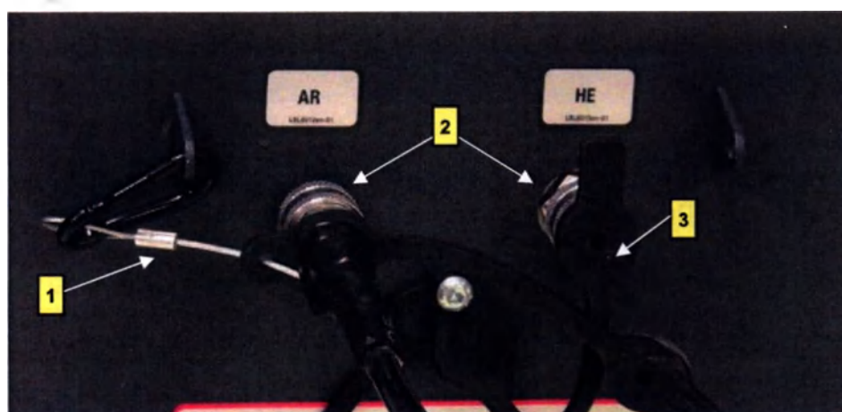
Рис. 8. Соединители для подачи газа в систему Visual-ICE
