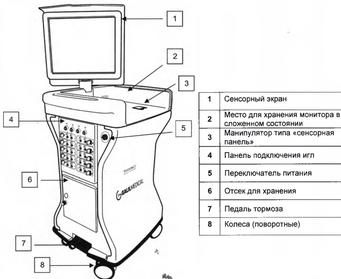
Рис. 1. Вид спереди криохирургической системы Visual-ICE
