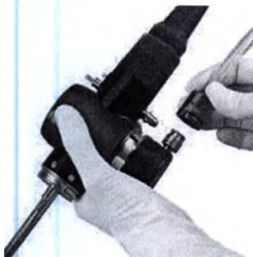
Рис.29. Присоединение адаптера проверки теста на герметичность.
