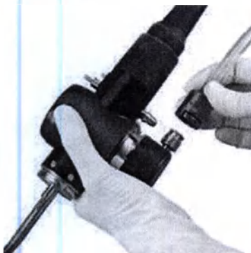
Рис.30. Присоединение адаптера проверки теста на герметичность.
