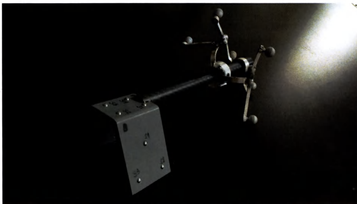
Рисунок 22 – Устройство калибровки АРХМ С-дуга с плоскпанельным детектором
