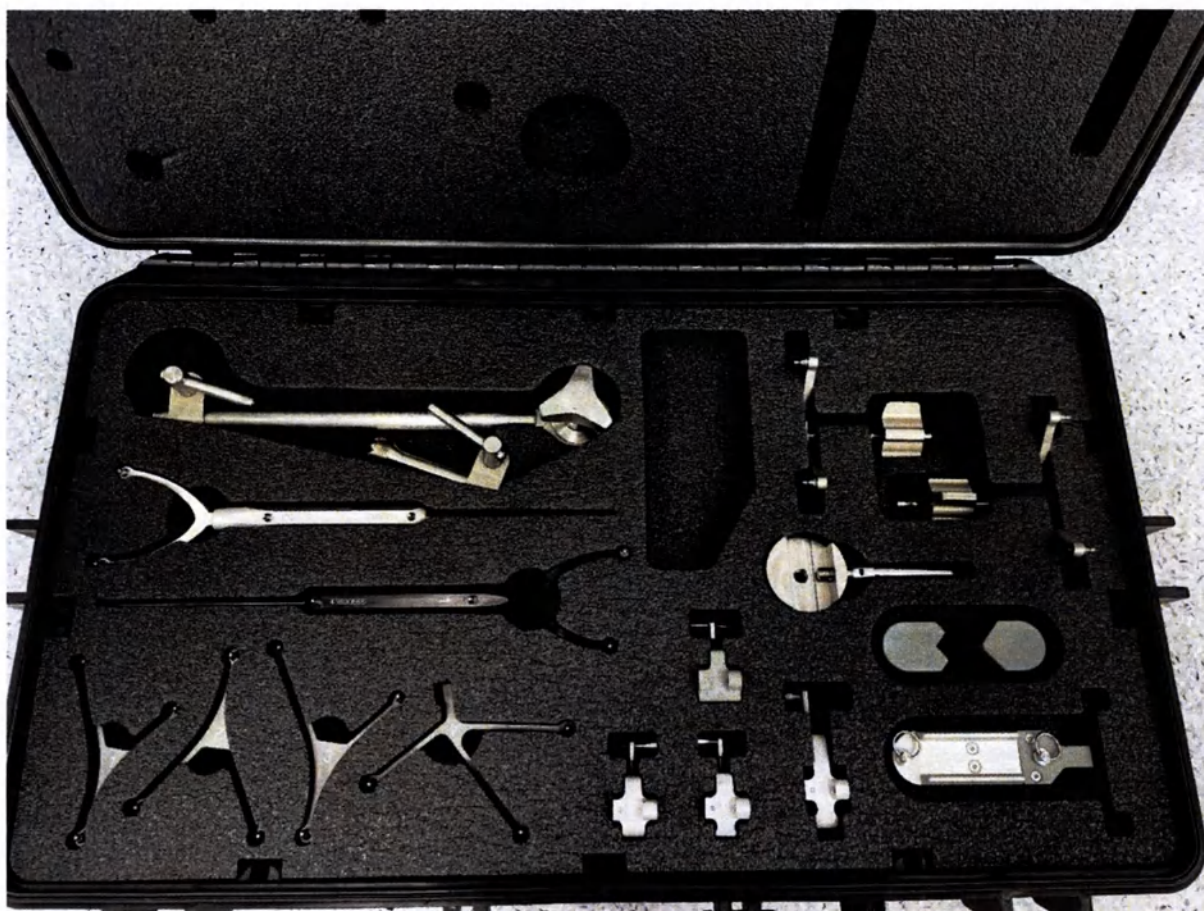
Рисунок 34 – Комплект элементов для идентификации инструмента или области оперативного вмешательства и устройства для их размещения в кейсе
