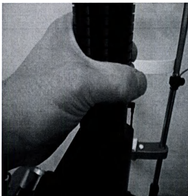
Рисунок 5.12 Поверните зум-модуль на 45 ° по часовой стрелке для его фиксации
