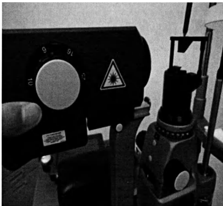
Рисунок 5.9 Установка блока микроскопа на щелевую лампу
