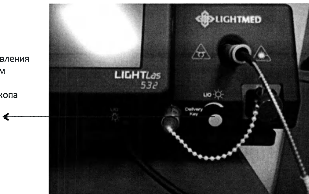
Рисунок 5.22(а) Передняя панель лазера с подключенным оптоволоконном и ключом типа подключенного устройства
