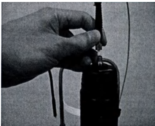
Рисунок 5.18 Подключение оптического волокна к зум-модулю
