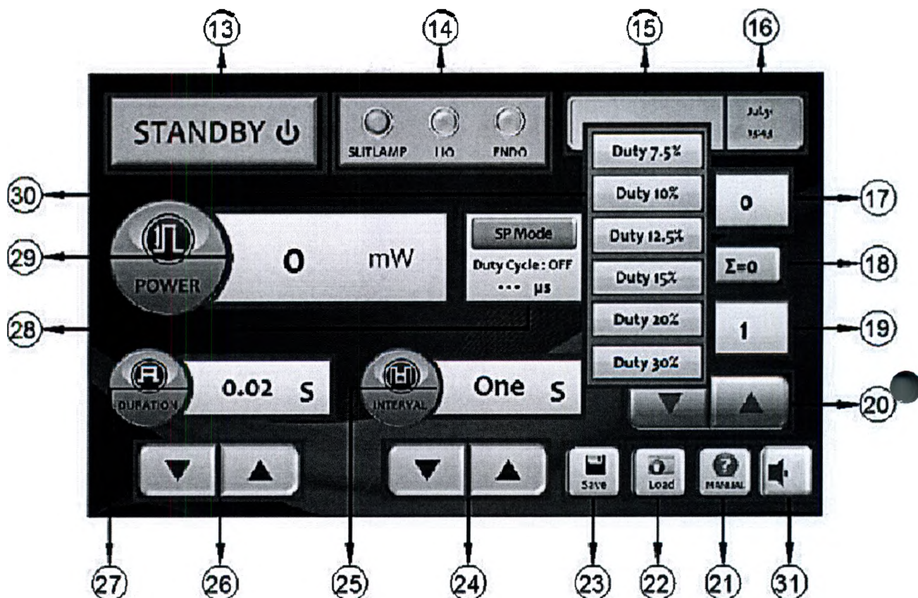
Рисунок 4.2 Органы управления параметрами излучения лазера LightLas на панели управления
