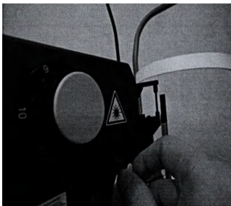
Рисунок 5.10 Надежно зафиксируйте блок микроскопа на щелевой лампе, полностью вставив его на монтажную пластину по направлению к хромированному стопорному винту.
